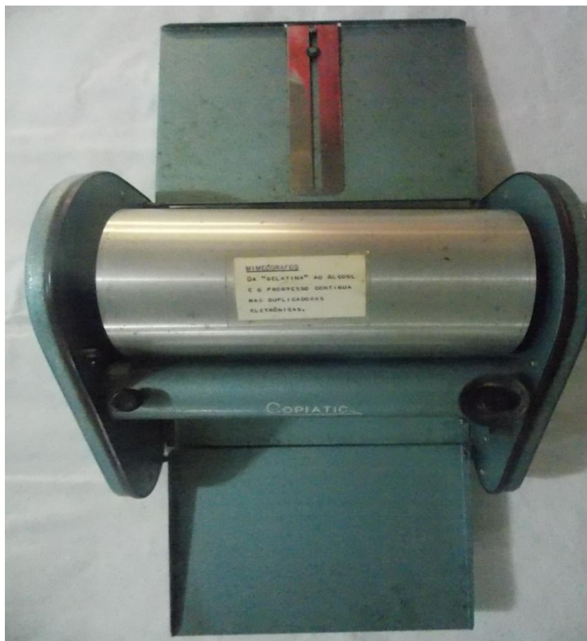
Figura 30 – Mimeógrafo : utilizado para fazer impressão de atividades aos alunos.
