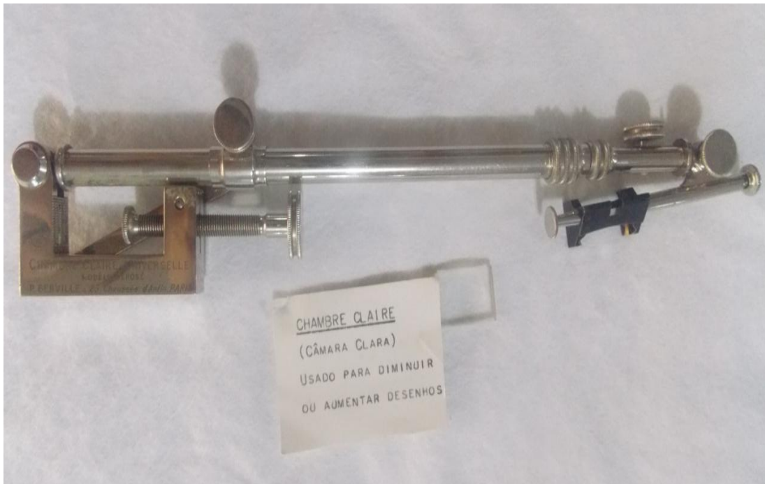
Figura 11 – Chambre Claire – utilizado na matéria de Desenho.
