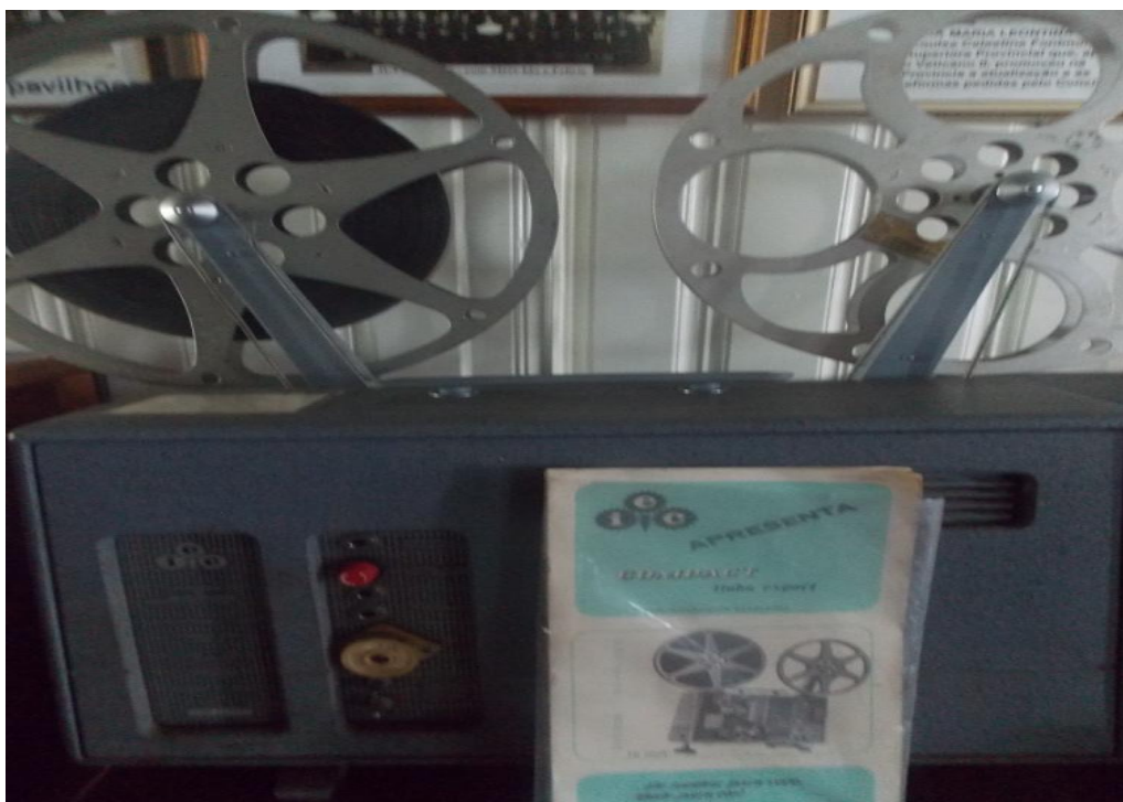
Figura 29 - Projektor Sonoro 16 mm – (Máquina de Cinema): usado aos domingos para passar filmes aos estudantes internos.
