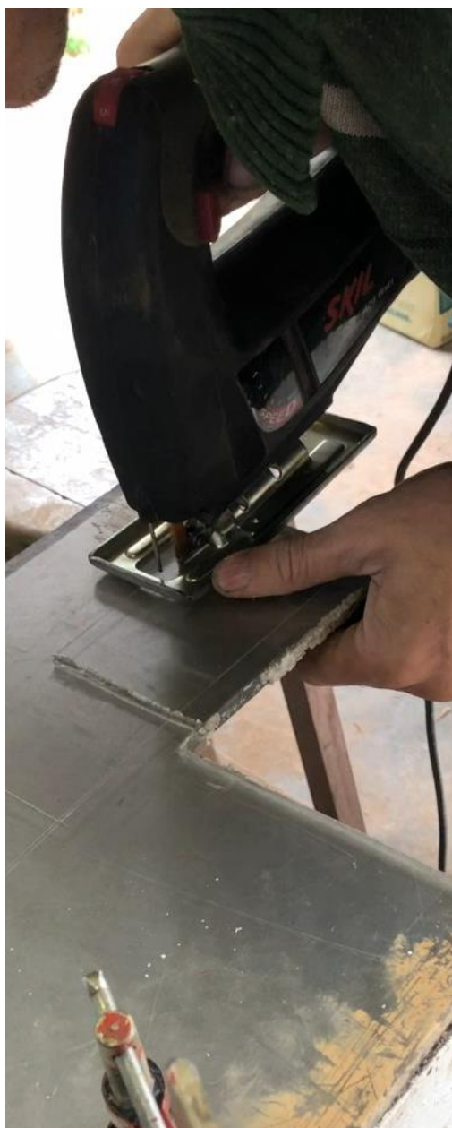
FIGURA 35 – Corte do acrílico para a produção de peça – Tetris analógico para autistas
