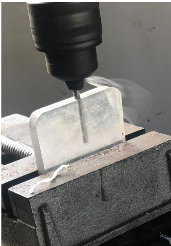
FIGURA 34 – Peça sendo perfurada para a inserção do led – Tetris analógico para autistas
