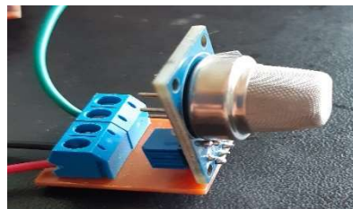
Figura 4 - Sensor de gás MQ-2 com placa de suporte feita pelo autor
