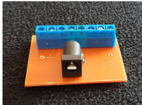
Figura 11 – Placa de expansão para alimentar os módulos relé, feito pelo autor.
