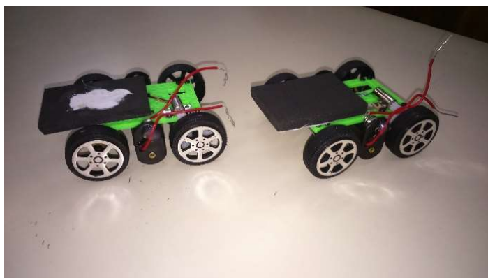
Figura 33: Base com rodas, motor e suporte de pilhas, onde foram fixados os robôs
